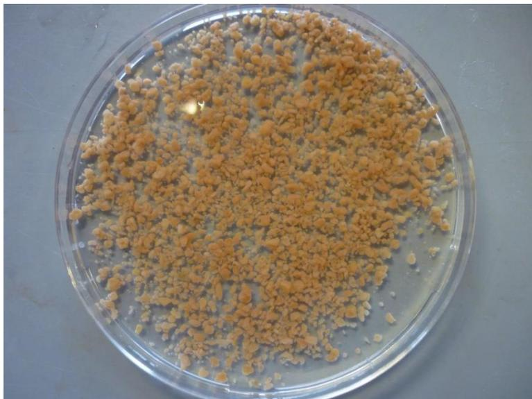
Fig. 1 – Lodo aeróbio granular, processo Nereda (fotos de grânulos desenvolvidos na COPPE/UFRJ)
